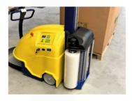
Regolazione della tensione del film tramite freno meccanico.
